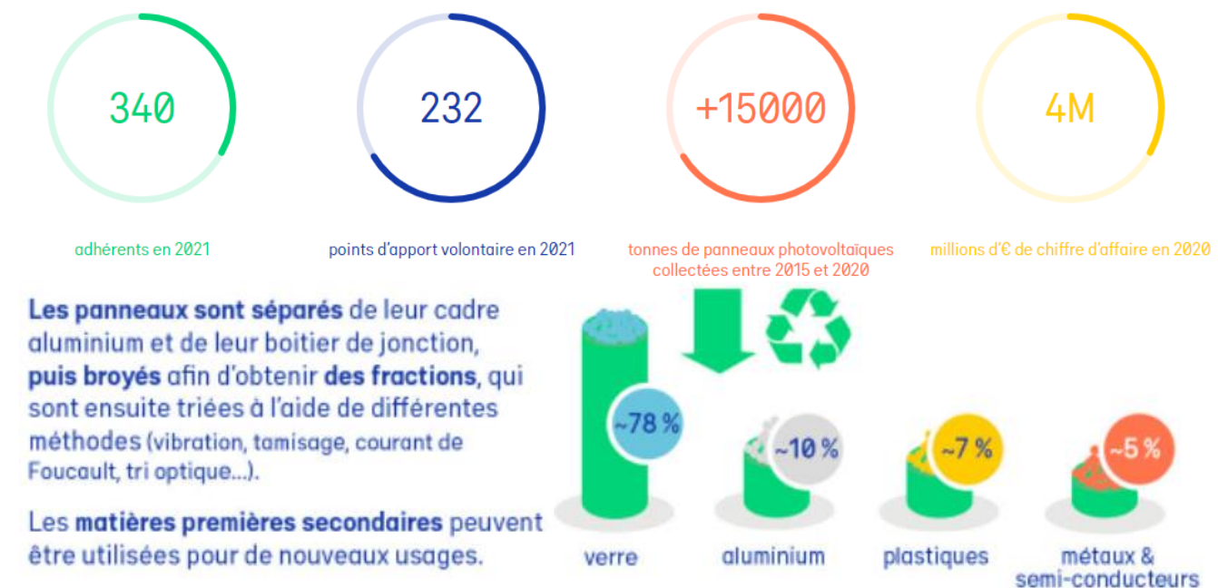
Figure 76 : Le traitement des panneaux photovoltaïques (source : Soren, 2022)
